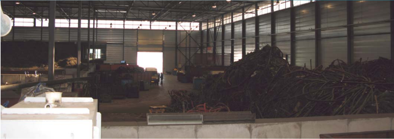
Overzicht van de ruime hal met op de voorgrond een berg grondkabel gereed voor verwerking in de shredder.
